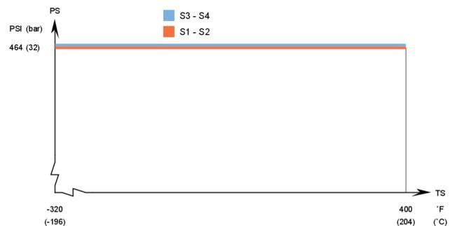
Предназначен для работы в условиях полного вакуума.
